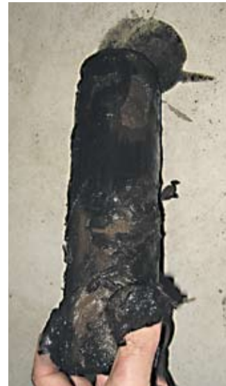
Kuue kuuga keskküttesüsteemist eraldunud sade
