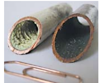
Soojaveetoru enne ja pärast Baueri seadme kasutamist
